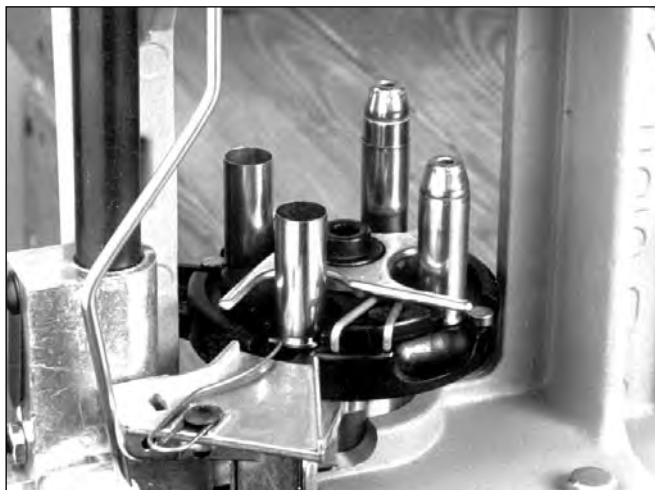
FIG. 16 - Eine vollgeladene Hülsenhalteplatte, direkt unter den entsprechenden Matrizen. Im Uhrzeigersinn von Station Eins, an dieser Station wird die Hülse kalibriert, das Zündhütchen entfernt und ein neues Zündhütchen eingesetzt. Beachten Sie die Hülsenhaltefeder, die die Hülse festhält. Station Zwei weitet den Hülsenmund (nur bei Pistolen) und füllt Pulver ein. Station Drei setzt das Geschoß ein. Station Vier crimpet das Geschoß.
