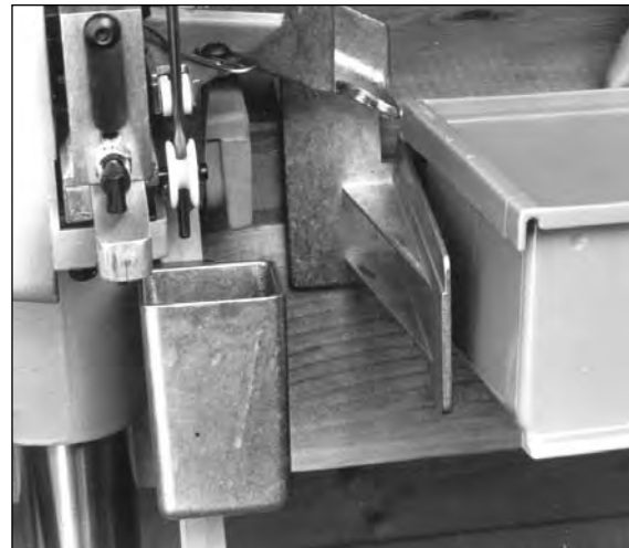
FIG. 3 - Der Patronensammelbehälter (#13839) wird einfach auf die Halterung geschoben und ist so in der richtigen Position.
