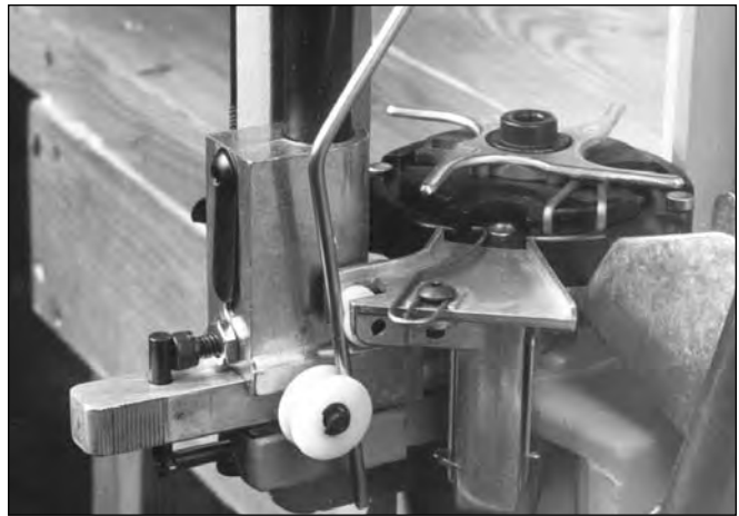
FIG. 11 - Hier sehen Sie die richtige Ausrichtung der Betriebsstange und die Position der Zündhütchenzuführung ganz nach vorne mit dem Zündhütchensetzstempel in der Plattform.
