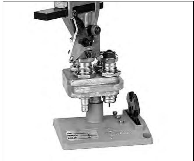
FIG. 15 - Ein kompletter, abnehmbarer Matrizenkopf mit allen Matrizen. Der Matrizenkopfstander ist Sonderzubehör.
