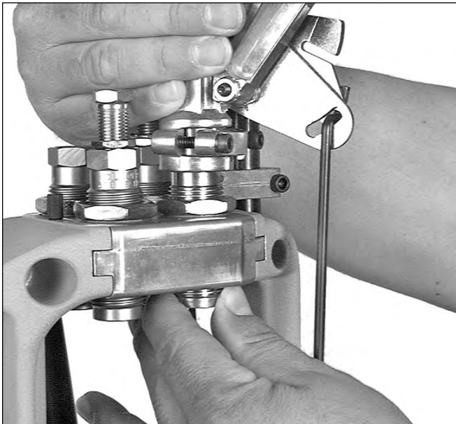
FIG. 19 - Die Pulvermatrize wird eingestellt, indem Sie die Matrize in den Matrizenkopf drehen, während Sie den Pulverfüller sicher von oben festhalten.
