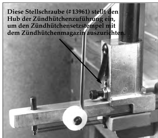
FIG.12 - Die Betriebsstange hat die Zündhütchenzuführung in den Zündhütchenzuführungskörper eingeführt, wo sie automatisch ein Zündhütchen aufpickt.
