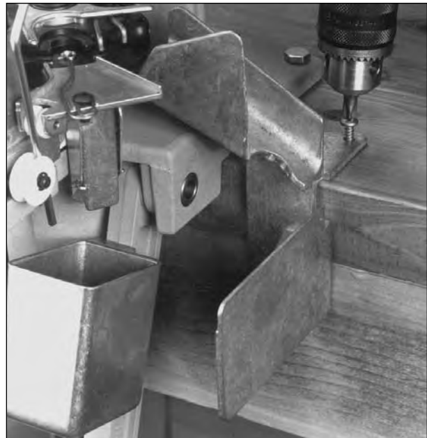
FIG. 2 - Dieses Photo zeigt die richtige Aufbauposition der Rutsche/Patronenbehälterhalterung in Bezug zur Maschine.
