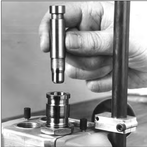
FIG. 18 - Lassen Sie den Pulvertrichter in die Pulvermatrize fallen, mit dem zugespitzten Ende zuerst. Der Trichter sollte sanft in der Matrize auf- und abgleiten.
