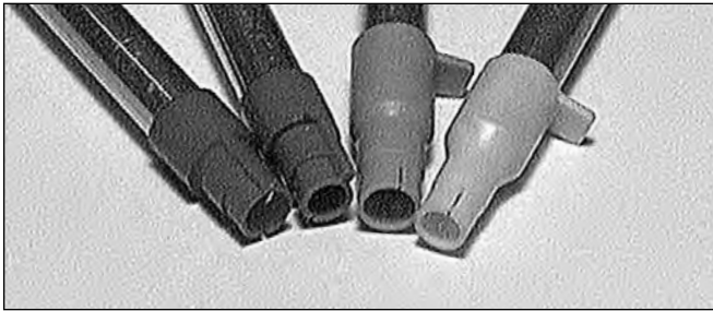
FIG. 14 - Die Maschine wird mit zwei Zündhütchenaufpickröhrchen (#20060 groß, #20059 klein) und zwei Zündhütchenmagazinröhrchen (#22031 groß, #22030 klein) geliefert. Sie sind zur leichteren Erkennung farbkodiert. Siehe Seite 14 für Farbkodierinformationen. Sie werden bemerken, daß die Zündhütchenmagazinspitzen einen Indexergrat haben, um bei Ihrem Einsetzen in das Zündhütchenzuführungssystem zu helfen.
