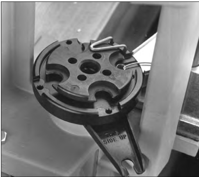
FIG. 6 - Die Hülsenhalteplatte in ihrer richtigen Position: unter dem Auswurfbügel mit der Hülsenhalterplattenummer nach oben.
