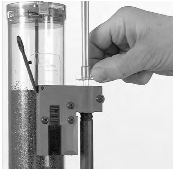
FIG. 25 - Lassen Sie die Zündhütchen in das Zündhütchenmagazin fallen.
