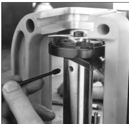
FIG. 10 - Setzen Sie die Messingschraube mit Messingspitze (#13923) und ziehen Sie diese fest an.
