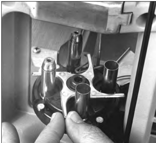
FIG. 9 - Dieses Photo zeigt die richtige Methode, die Hülsenhalteplatte zu indizieren und die richtige Installation der Abstandhalter.
