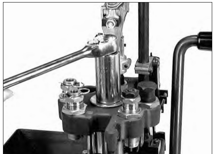
Fig. 21: Utilisez une clef de 28 pour enlever le boulon de la tête de presse.
