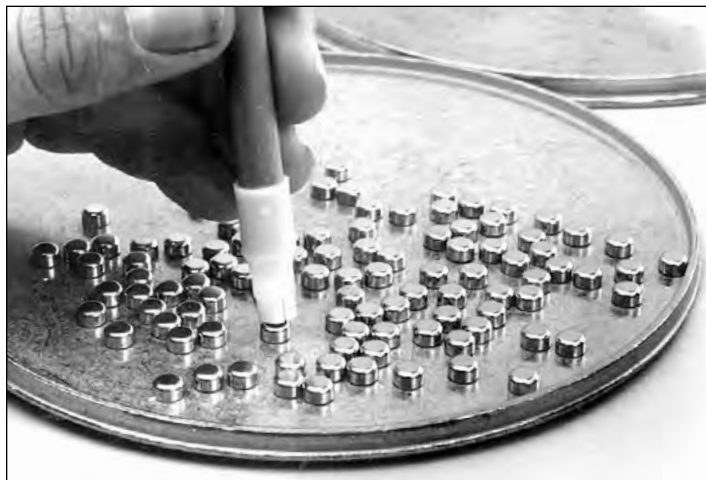
Fig. 13: Toutes les amorces doivent être disposées avec le côté brillant vers le haut.
