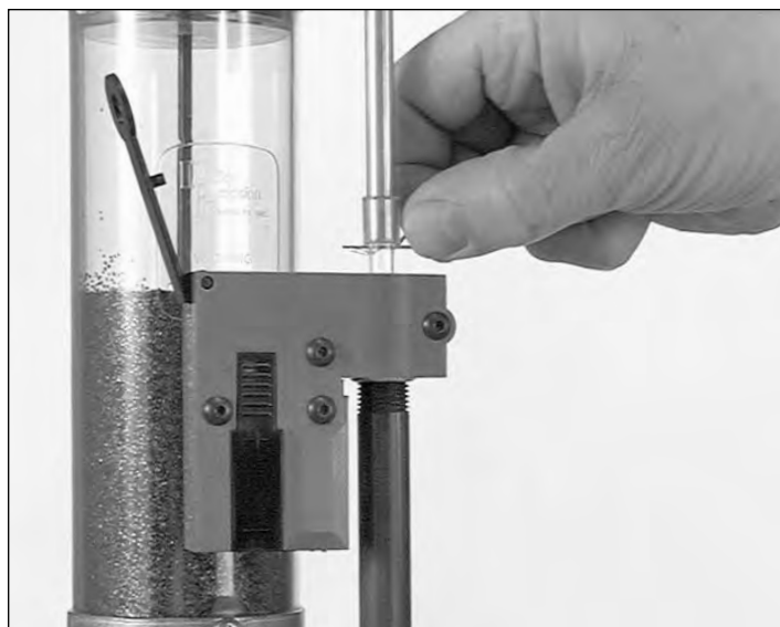
Fig. 14: Quand vous installez les amorces dans le tube à amorces, assurez-vous que le tube de collecte est bien centré avant d'enlever le clip.
