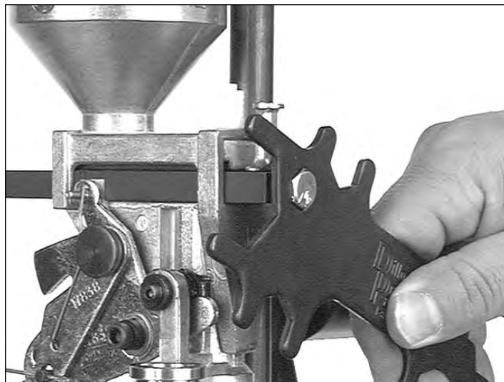
Fig. 11: Tournez le boulon de réglage du tiroir à poudre dans le sens des aiguilles d'une montre pour augmenter la charge de poudre et inversement pour la diminuer.
