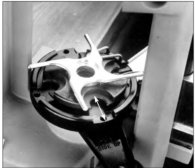
Fig. 7: Cette photo montre le pignon de rotation dans la bonne position: les pattes de positionnement sont bien centrées sur le plateau porte-étui.
