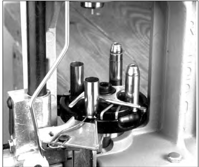
Fig. 16: Un plateau porte-étui entièrement garni et directement en dessous des outils correspondants. Dans le sens des aiguilles d'une montre, et à partir du Poste 1, l'étré, à ce poste, est recalibré, désamorcé et réamorcé. Remarquez que le ressort de maintien de l'étré tient celvi-ci en place. Au Poste 2, l'entrée de l'étré est évasée (pour les pistolets seulement) et la charge de poudre est versée. Au Poste 3, la balle est enfoncée et sertie au Poste 4.
