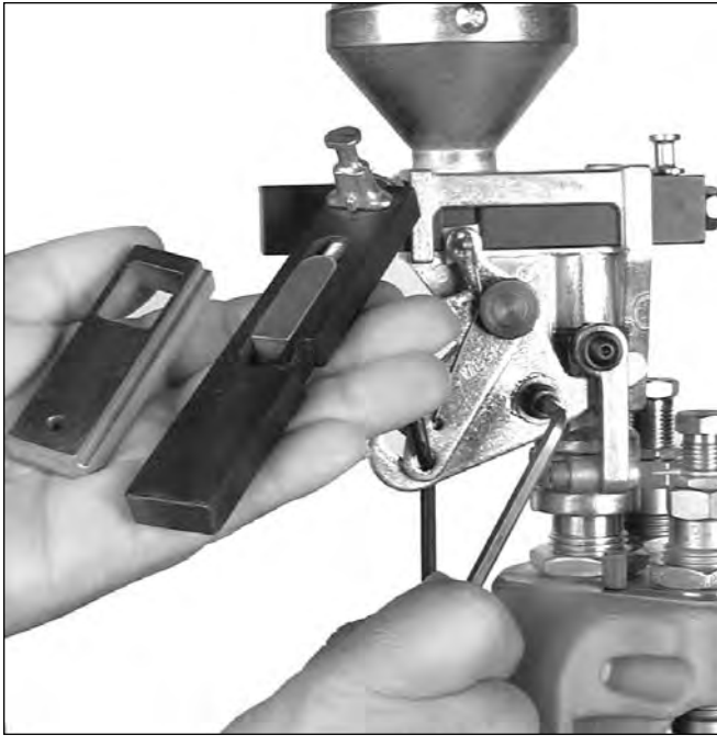
Fig. 23 - Desserrer suffisamment la vis (#13904) de la came vous permet de sortir le tiroir à poudre. Insérer le nouveau tiroir à poudre et resserrer la vis.
