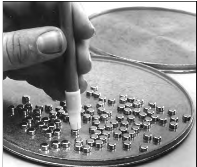
Fig. 24: Utilisation du tube de collecte des amorces et du récipient de tri des amorces.
