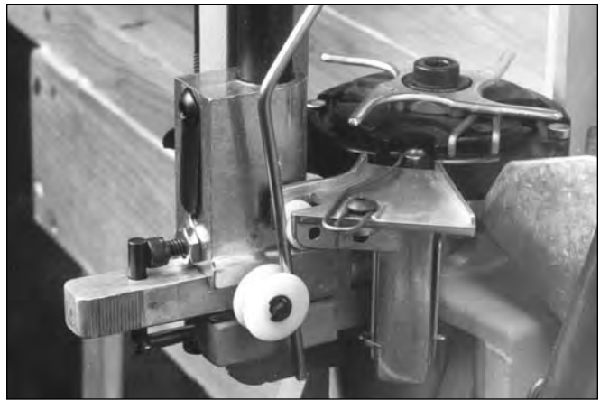
Fig. 11: Voici le bon alignement de la tige de transmission et la position du distributeur d'amorces complètement engagé, avec l'amorceur dans la plate-forme en position basse.
