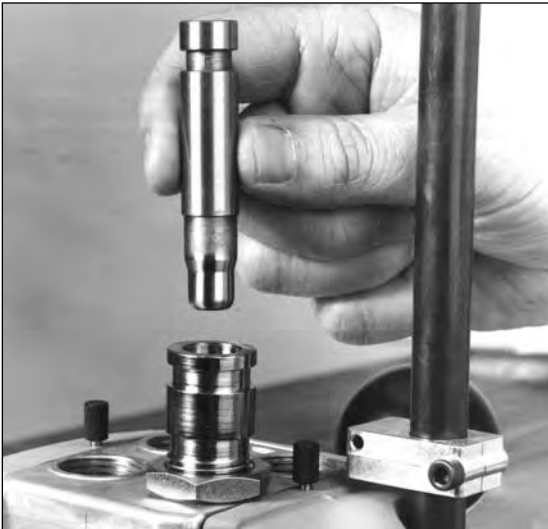
Fig. 18: Mettez l'entonnoir à poudre dans l'outil à poudre. Celui-ci doit pouvoir jouer librement dans l'outil.
