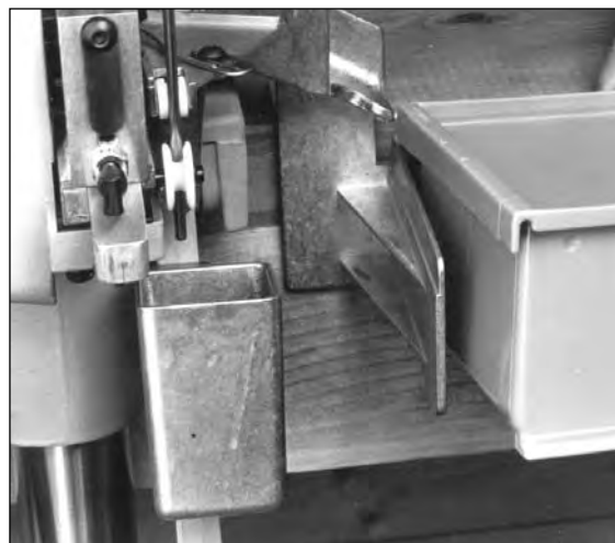
Fig. 3: La boîte de collecte des cartouches (#13839) vient alors simplement se glisser sur le support (voir Fig. 3) et se retrouve dans la bonne position pour recueillir les cartouches chargées éjectées.
