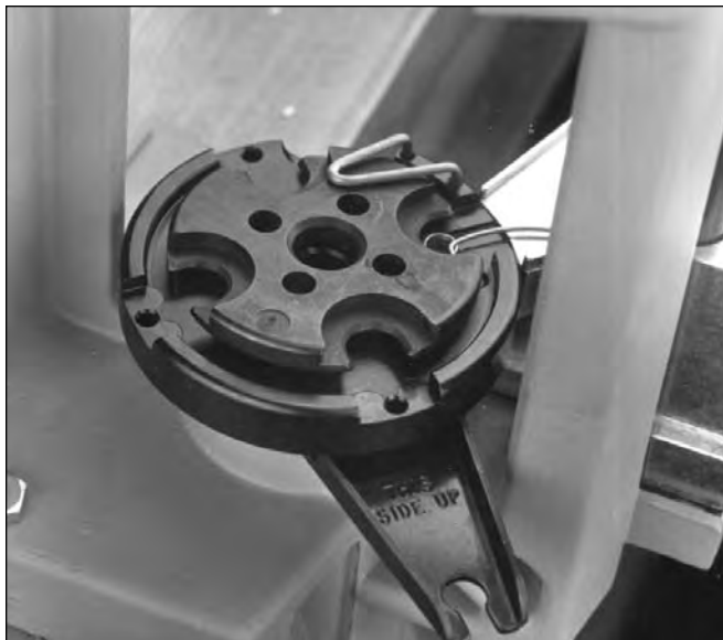
Fig. 6.: Vue du plateau porte-étui dans sa position correcte: sous la barre d'éjection, avec le numéro du plateau vers le haut.
