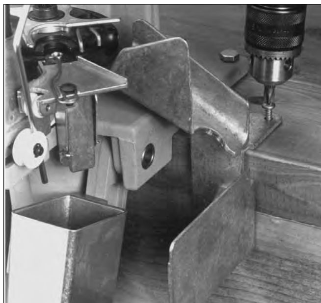
Fig. 2: Cette photo montre la position de montage correcte pour le support de la boîte de collecte des cartouches par rapport à la presse.
