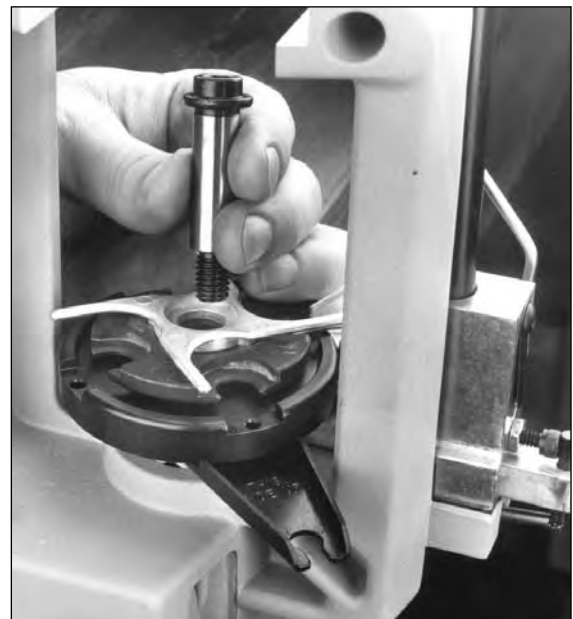
Fig. 8: L'introduction du boulon du plateau porte-étui qui passe d'abord à travers le pignon de rotation puis dans le plateau lui-même.
