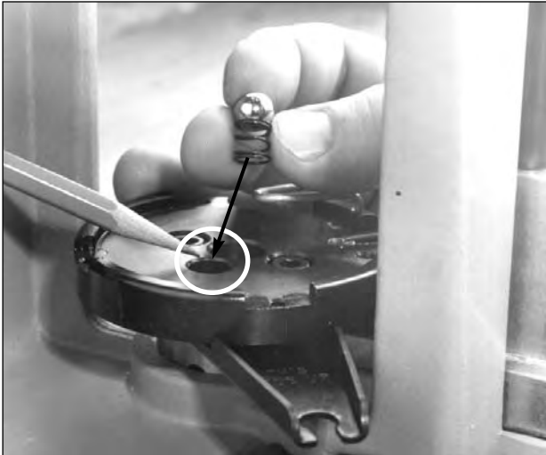
Fig. 5: Cette photo montre la mise en place du ressort et de la bille sur la plate-forme.
