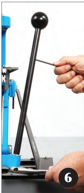
Introduzca una llave hexagonal de 5/32 pulgadas o un destornillador a través del agujero de la palanca para sujetarla mientras ajusta la tuerca de seguridad con una llave de 7/8 pulgadas o una llave inglesa.
