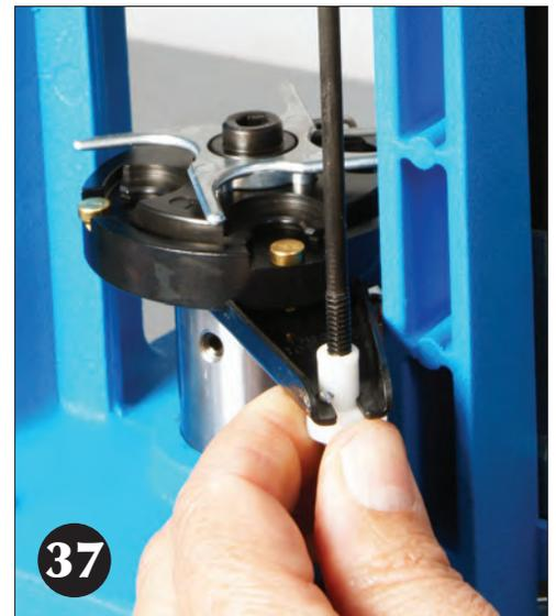
Cuando el dosificador de pólvora y la varilla de seguridad estén posicionadas correctamente, la varilla debería estar próxima al soporte de la varilla aseguradora dentro del cual quedará colocado. Coloque el cojinete blanco en la hendidura del soporte de la varilla aseguradora y presiónelo hasta que quede bien colocado como se muestra en las fotografías 36 y 37.
