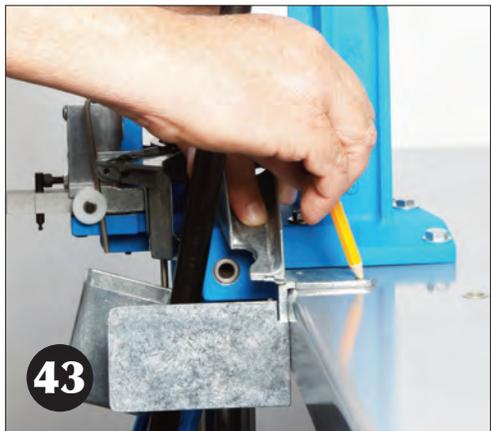
Si no está utilizando la montura estabilizadora de la RL550 C, usted ya puede colocar el soporte del vertidor de rondas a su mesa, permitiendo aproximadamente 1/8" de espacio entre la plataforma y el canal de expulsión de rondas.
