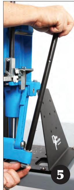
Extraiga la arandela y la tuerca de seguridad del paquete de ensamblaje de la palanca. Coloque la arandela sobre el orificio en la parte derecha de la barra eje e inserte la palanca a través de él. Coloque la tuerca de seguridad en la palanca manualmente.
