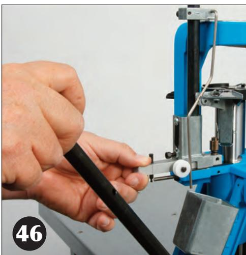
Para cambiar el sistema de fulminantes deberá, en primer lugar, extraer la varilla operadora elevando la plataforma levemente y tirar hacia atrás el deslizador de fulminantes.
