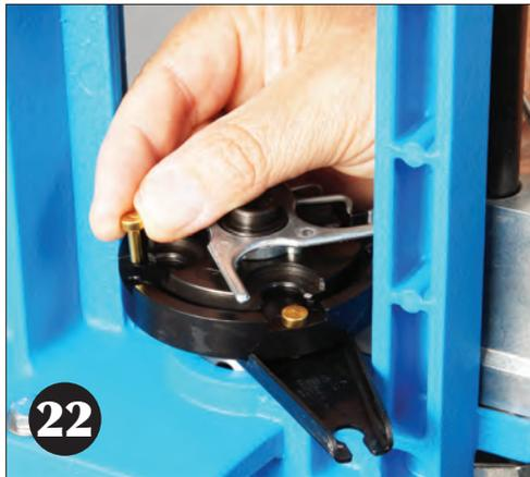
Ahora ya puede colocar las piezas localizadoras (de la caja de conversión de calibres de la RL 550B) en los agujeros que quedan en la plataforma. Su posición correcta se muestra en la imagen 23.
