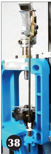
Si se instala correctamente, la varilla de seguridad debería verse igual que en la fotografía 38.
