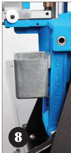
Coloque el recipiente de fulminantes gastados en el punto de montaje con forma de cuña en el brazo conector izquierdo.
