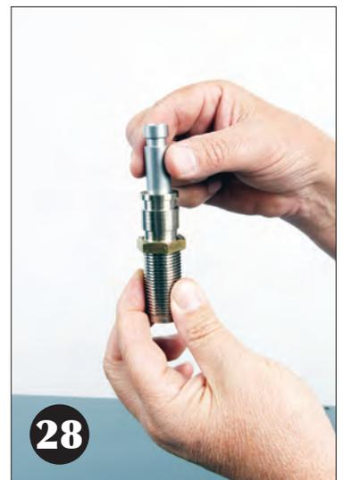
Utilice una llave hexagonal de 5/32 pulgadas para aflojar las dos abrazaderas en el dosificador de pólvora y extraiga el dado de pólvora. Coloque el embudo de pólvora (empaquetado dentro de la caja de conversión de calibres de la RL 550B) en el dado de pólvora con la parte del canal hacia arriba tal y como se muestra en la fotografía. El embudo de pólvora ha de poder subir y bajar sin problema.
