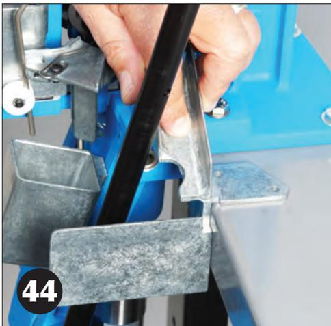
Utiliza dos tornillos para asegurar el vertidor a su mesa. La caja recipiente de rondas simplemente conecta al vertidor y estará colocado correctamente para recibir las rondas cargadas.
